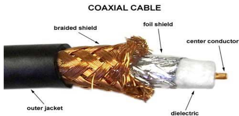
រូបភាព ២.២០ Coaxial Cable
